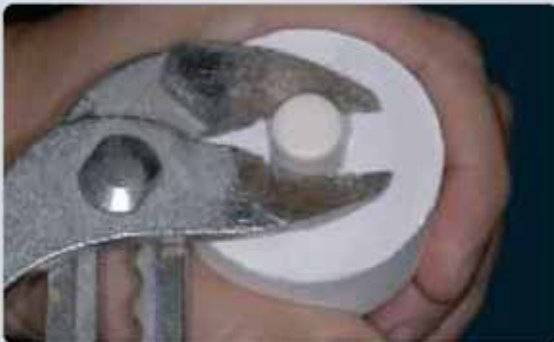
Przebrać pierścien tarcza w oznaczonym miejscu.
