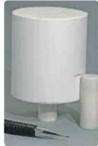
Odnaczyć na pierścieniu długość tłoka.
