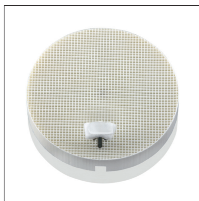
Ryc. 1: Ułożenie próbki w połowie długości promienia podstawki.
